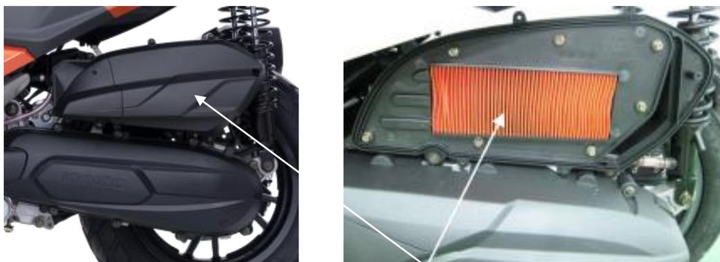
1. Retire os parafusos e a tampa da caixa do filtro de ar.
